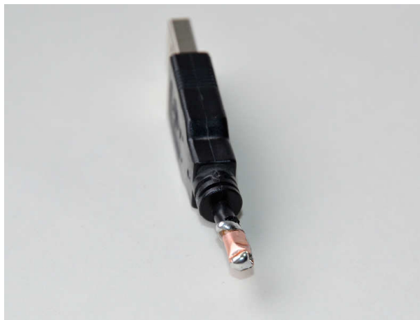
Bild 32 Schirmen des gesamten Kabelendstückes mit Cu-Folie (Abschlusswiderstand an Cu-Folie anlöten, Abschlusswiderstand und Signaladern isolieren)
