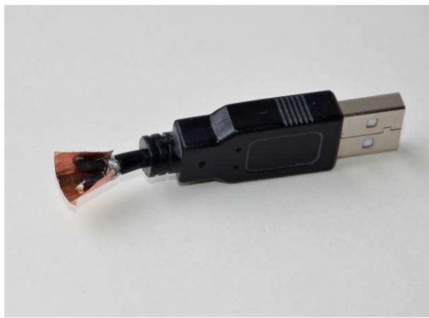
Bild 31 Das zu messende Aderpärchen wird gebrückt und mit 50 Ohm abgeschlossen (Bezugkontakt ist Kabelschirm).
